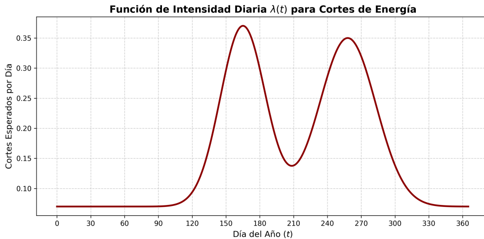
Figura 3.1: Función de intensidad de fallas eléctricas \lambda(t) a lo largo del año. El modelo base suma el ruido constante del sistema más dos núcleos gaussianos que representan la temporada de estiaje/ola de calor (alrededor del día 165) y la temporada de huracanes (alrededor del día 258).
