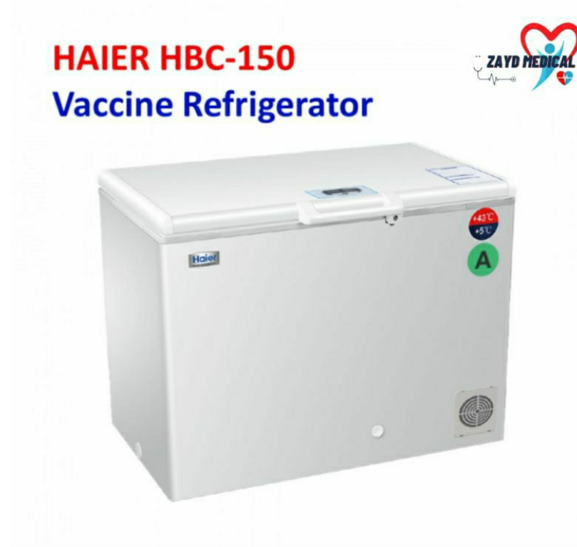
Figura 3.2: Refrigerador institucional para vacunas Haier HBC-150 (Icelined Refrigerator). Este equipo tipo cofre cuenta con certificación PQS de la OMS y masa térmica incorporada para garantizar la red de frío durante cortes prolongados de energía eléctrica.
